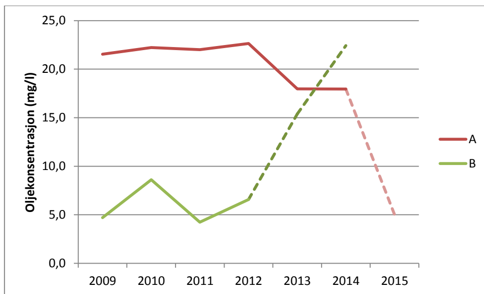
Figur 6-2. Oljekonsentrasjon (mg/l) for to felt før og etter (stiplet linje) installering av ny plattform med ny renseteknikk for produsert vann.
